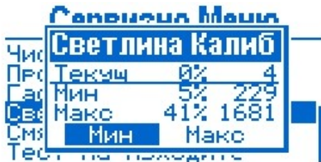
Фиг 16 Калибриране на светлинния сензор
